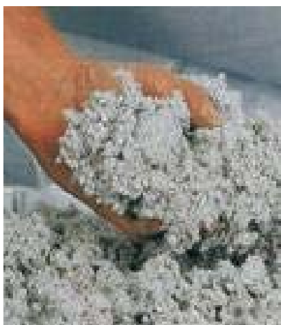
cellulosa: 0,040 W/m·K (10% Borato di sodio, ignifugo e fungicida)
