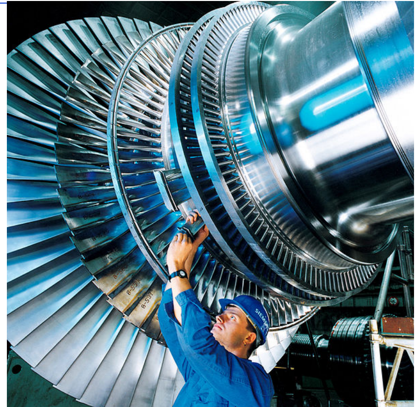
Schaufeln eines Dampfturbinenrotors bei der Wartung
