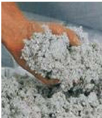
Zellulose: 0,040 W/m·K (10% Borax, Feuerschutz und Fungizid)
