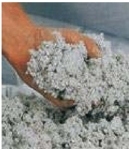
Celuloza: 0,040 W/m·K (10% Boraks, ochrona przed ogniem i środek grzybobójczy)
