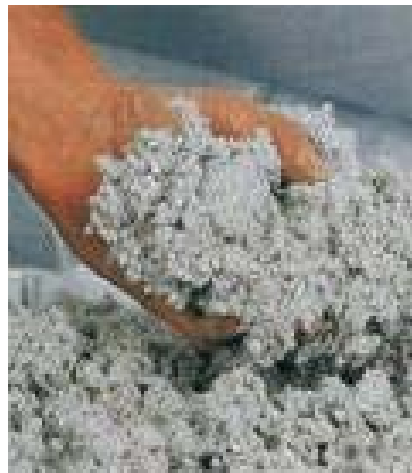
Celuloză: 0,040 W/m·K (10% Borax, Ignifugare și fungicid)
