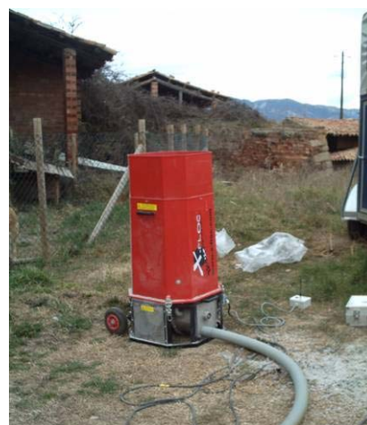
Celulosa: 0,040 W/m·K (10% Bórax, protección ignífuga y fungicida)
