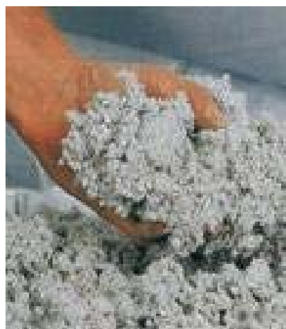
Celulosa: 0,040 W/m·K (10% Bórax, protección ignífuga y fungicida)
