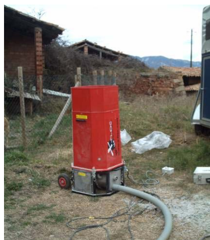
Cellulosa: 0,040 W/m·K (10% Borax, brandskyddande och svampdödande)
